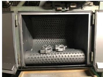
●回収した部品は分解、洗浄し、プラスト加工をする
