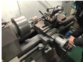
●部品によっては旋盤機を使い、手作業で新品のように仕上げる
